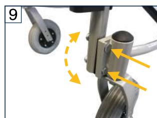
Pour régler ou déplacer la chasse des roues avant, desserrez tout d'abord les deux vis de blocage. La chasse peut alors être réglée en faisant pivoter vers la droite ou vers la gauche. (fig. 9) .
