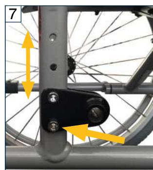
De zithoogte kan op 3 niveaus worden ingesteld. Als u de hoogte wilt verstellen, drukt u op de ontgrendelingsknop om de beide hoepelwielen te verwijderen (zie het gedeelte Wiel aanbrengen).
