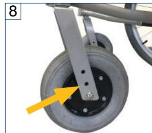
De zithoogte voor kan op 3 niveaus worden ingesteld en wordt aangepast aan de gewenste hoek van de zitting. Als u de hoogte wilt verstellen, opent u de schroef van de wielaas en trekt u deze eruit.
