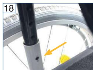
Pour déplacer les poignées de poussées desserrez les écrous situées à droite et à gauche, en bas du tube de guidage des poignées de poussées (fig 18). Retirez les vis.
