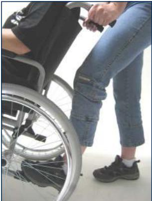
Wanneer u de rolstoel over stoepranden en drempels wilt rijden, drukt u met één voet (links of rechts) krachtig op de kantelhulp terwijl u de duwgrepen omlaag drukt. Hiermee wordt de rolstoel aan de voorzijde gemakkelijker opgetild. Zorg dat u hierbij stevig staat.
