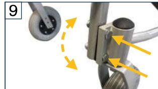
**De schroeven moeten na het instellen weer vast gedraaid worden. Controleer na het instellen of de voorvork goed vast zit.**
