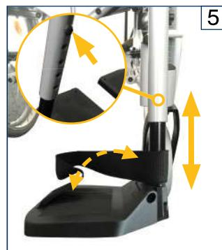
Draai de schroef van de voetsteun met de bijgeleverde inbussleutel los en stel de lengte naar wens in door verschuiving naar boven of naar beneden.
