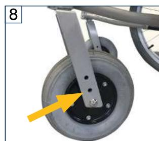
La hauteur du siège à l'avant est réglable à 3 hauteurs différentes et permet d'ajuster l'inclinaison souhaitée pour le siège. Pour la régler, desserrez la vis de l'axe de roue et retirez-la. Les bouchons des trous sont facilement interchangeables.
