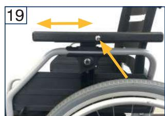
Pour régler la longueur du repose-bras, pour des - serrer la vis se trouvant à l'extérieur, au milieu du repose-bras, qu'il est alors possible de faire coulisser dans la position souhaitée. (fig 19) .
