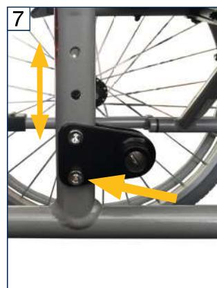
Le siège peut être réglé à 3 hauteurs différentes. Pour le régler, retirez les deux mains-courantes en actionnant les boutons de déverrouillage (voir la section intitulée « Montage des roues »). Desserrez l'écrou du support de roue et déplacez ce dernier dans le trou souhaité. Replacez l'écrou avec sa rondelle d'arrêt et resserrez-le. (fig. 7) .
