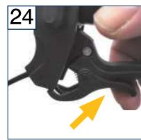
Pour freiner le fauteuil roulant, pressez les deux poignées de frein au niveau des poignées de poussée. Pour bloquer les freins (p. ex. pour un arrêt complet), il est possible de verrouiller les poignées de frein en position de freinage en pressant simplement le crochet de verrouillage vers l'avant avec le doigt jusqu'à enclenchement. Pour déverrouiller les freins, pressez le crochet vers l'arrière. (fig. 23+24) .
